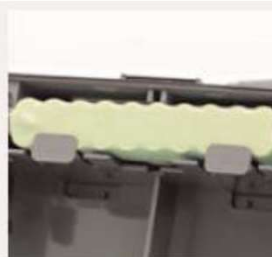
BATTERIES DE SECOURS
